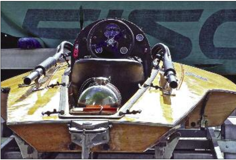
L'angusto abitacolo dello scafo del 1969 pilotato da Pietro Silva, motorizzato con un Lancia Flaminia da 2.500 cc
