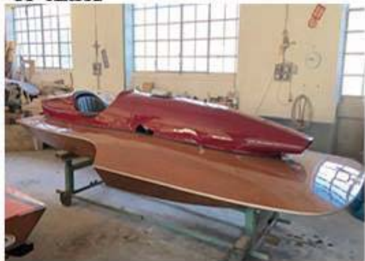
Nelle foto sotto la carrozzeria e lo scafo durante il restauro nel cantiere Lucini
