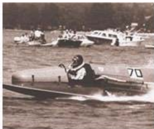
Nata con guida avanzata con carrozzeria in alluminio, poi modificata a guida tradizionale
