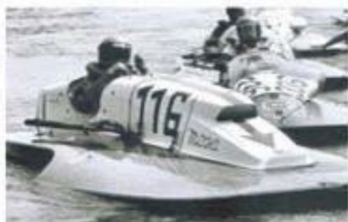
Trasformata a guida tradizionale con carrozzeria in alluminio Celli nel 1971
